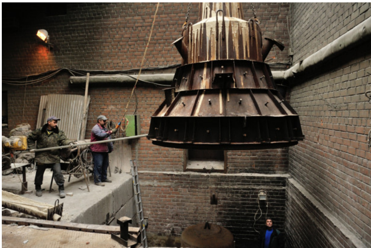
Κατ' αρχήν η καμπάνα σχεδιάζεται στο γραφείο και στη συνέχεια, με βάση το σχέδιο οι κατασκευαστές παράγουν τα πρότυπα και καλούπια.
