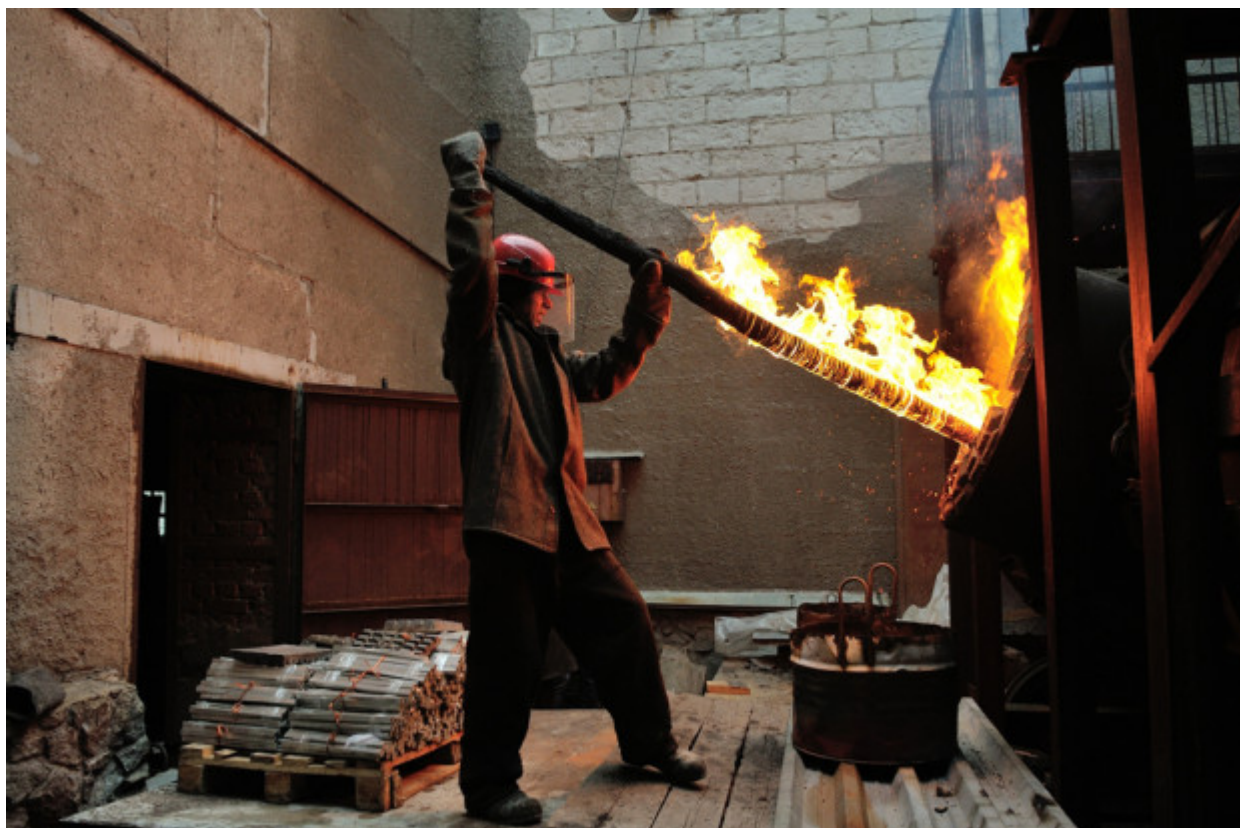
Η θερμοκρασία στον κλίβανο φθάνει κοντά στους 1200° C. Ένας εργάτης ανακατεύει κατά διαστήματα το “παρασκεύασμα” με ένα μακρύ κορμό. Ο κορμός απανθρακώνεται μπροστά στα μάτια του.
