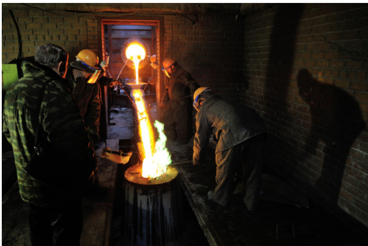
Το υγρό μέταλλο ρέει φλεγόμενο προς του άνοιγμα του μαύρου καλουπιού.
