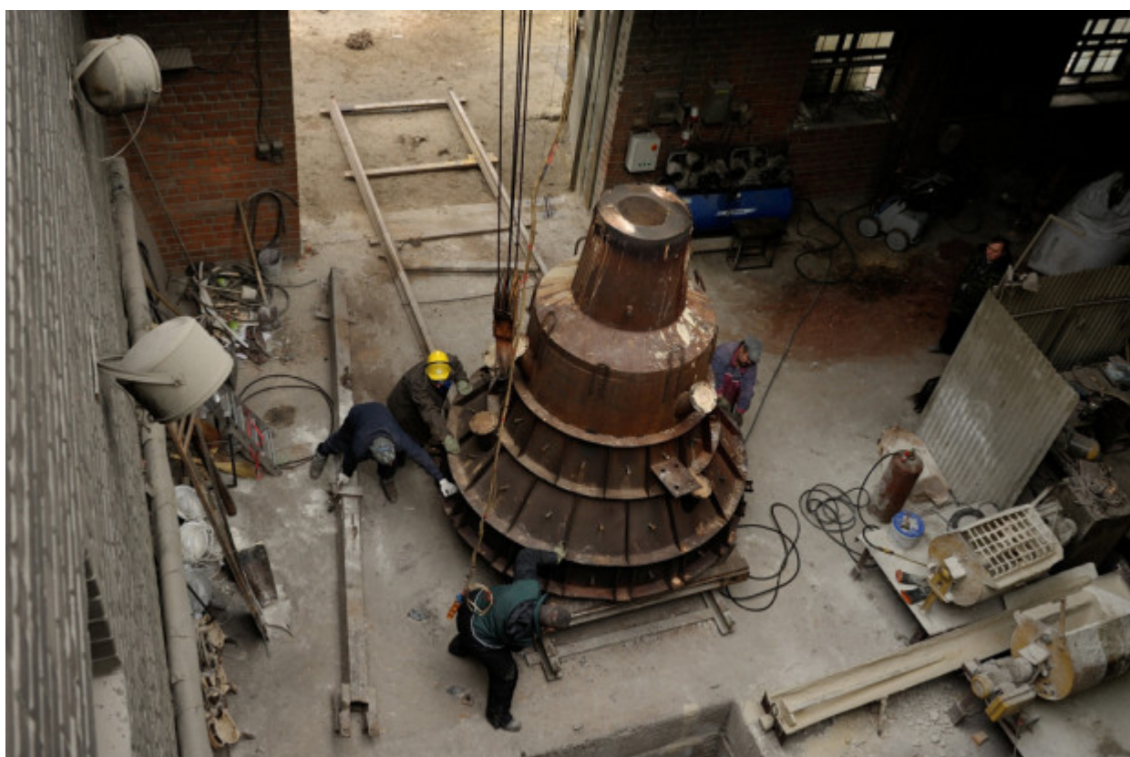
Τα συστατικά μέρη είναι από πριν καθορισμένα, έτσι ώστε το διάστημα μεταξύ τους είναι ακριβώς το ίδιο με το πάχος του τελικού προϊόντος, και αυτό ακριβώς είναι ζωτικής σημασίας για την αναπαραγωγή ήχου.
