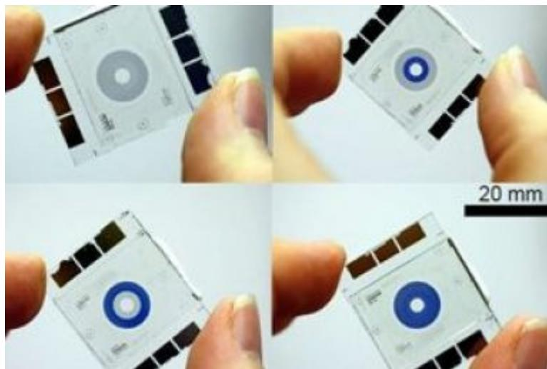
Γερμανοί ερευνητές δημιούργησαν μια μικροσκοπική και πολύ λεπτή ίριδα φακού, πολύ μικρότερη από τις υπάρχουσες μηχανικές ίριδες, γεγονός που ανοίγει το δρόμο για την κατασκευή μιας νέας γενιάς μικροσκοπικών καμερών για τα «έξυπνα» κινητά τηλέφωνα και τους υπολογιστές-ταμπλέτες.
