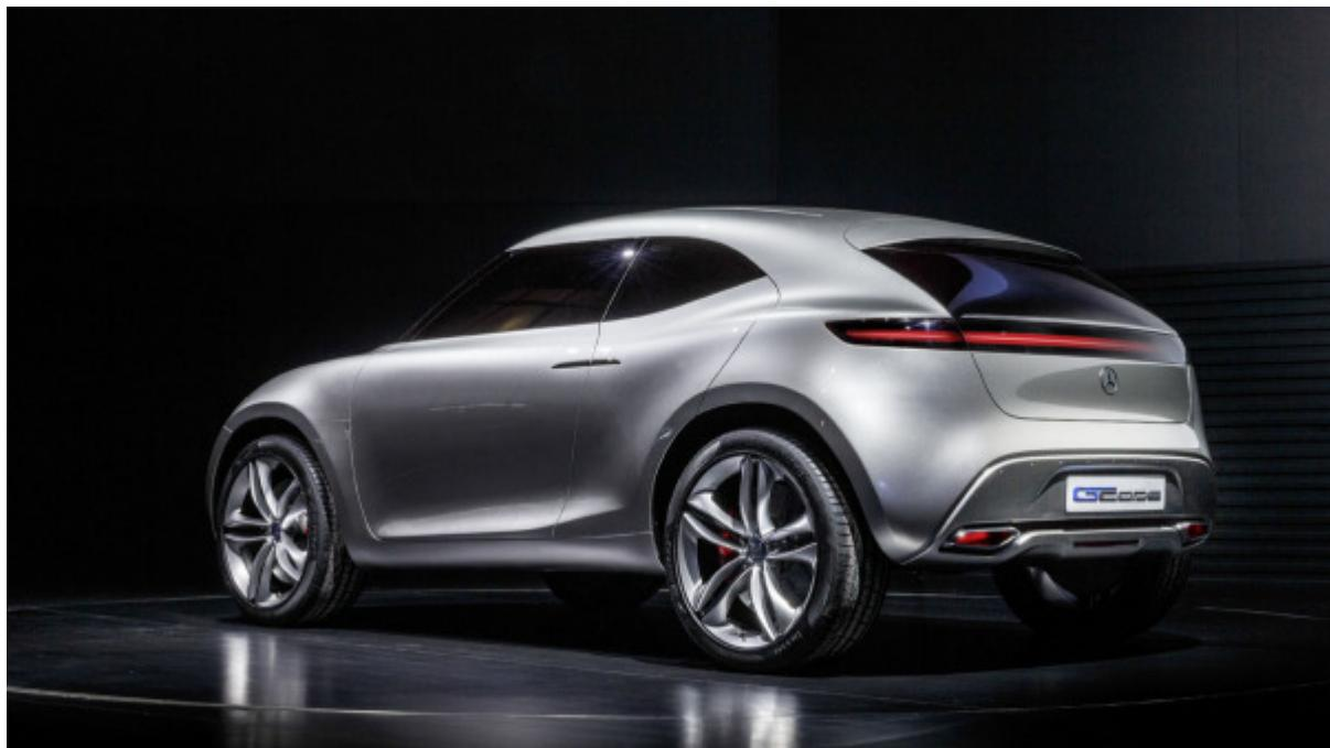
Το ύψος και η απόσταση από το έδαφος επιτρέπουν να μιλήσει κανείς, όπως ήδη είπαμε, για όχημα με δυνατότητες κίνησης εκτός δρόμου, ενώ ο ηλεκτροκινητήρας που κινεί τους πίσω τροχούς, με τη βοήθεια ενός διπλού πολύδισκου συμπλέκτη, εξασφαλίζει τη μετάδοση της κίνησης σε όλους τους τροχούς.
