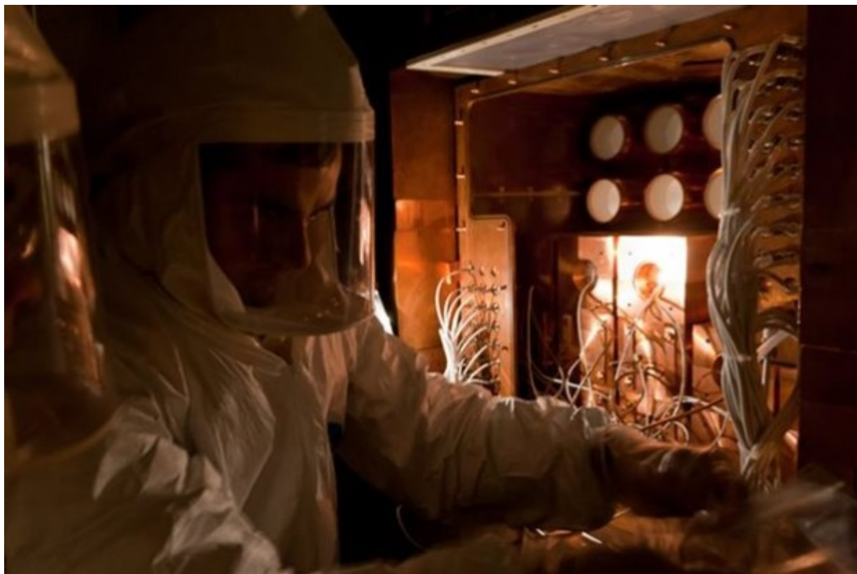
Ο ανιχνευτής DAMA χρησιμοποιεί κρυστάλλους ιωδιούχοι νατρίου (οι λευκοί κύκλοι δεξιά) μονωμένους με χαλκό
