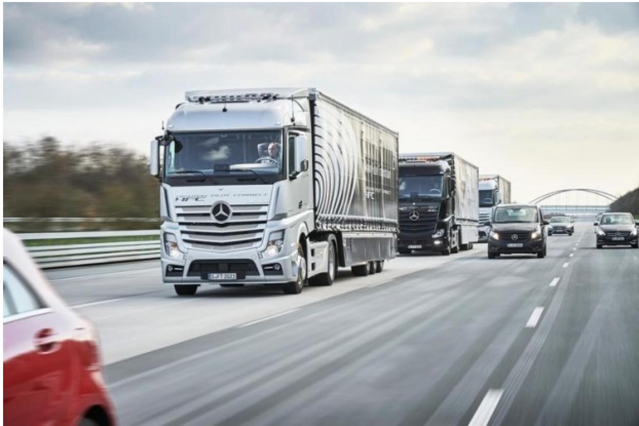
*Mercedes-Benz Actros Lkw nutzen das System Highway Pilot Connect zur vernetzten Fahrt im Verbund (Truck Platooning)*
