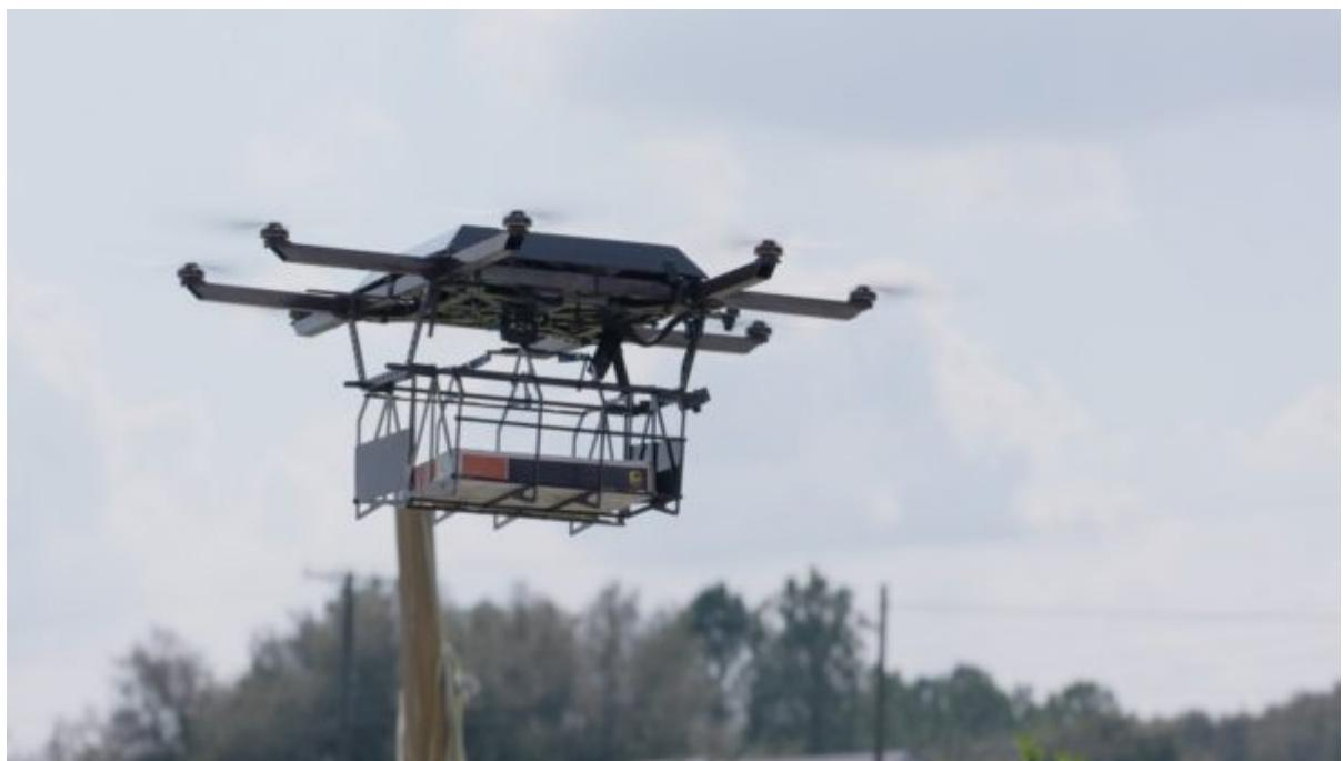
Το drone που χρησιμοποιήθηκε στη δοκιμή της Δευτέρας ήταν το σύστημα παραδόσεων UAV Workhorse HorseFly. Πρόκειται για ένα υψηλής απόδοσης, οκτακόπτερο drone παραδόσεων, το οποίο έχει ενσωματωθεί πλήρως στη γραμμή ηλεκτρικών/υβριδικών φορτηγών της Workhorse.
