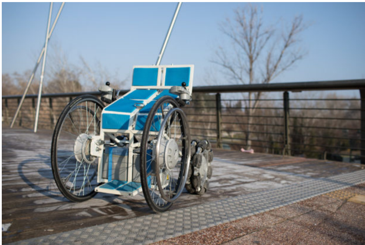
Το πρωτοποριακό ηλεκτροκίνητο αναπηρικό αμαξίδιο που δίνει τη δυνατότητα στο χρήστη να στέκεται με πολύ απλό τρόπο όρθιος και να κινείται ξεπερνώντας εμπόδια
